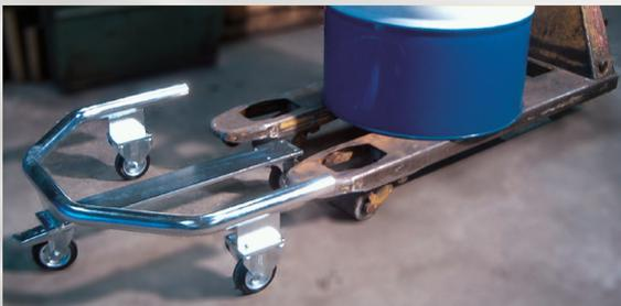
Einfacher und sicherer Transport von Trommeln, die aufrecht stehen müssen. Der Trommel ist mit Handhubwagen oder Gabelstapler leicht zu hantieren. Die Höhe des Wagens ist an einer Euro-Palette angepasst, so dass der Trommel auch zu und von der Palette gezogen werden kann.
